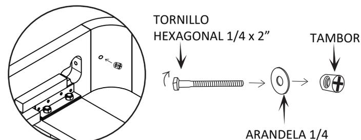
**!** UNA LARGUERO Y PIECERO CON EL TORNILLO HEXAGONAL AJUSTE CON LLAVE FIJA DE 1/2
