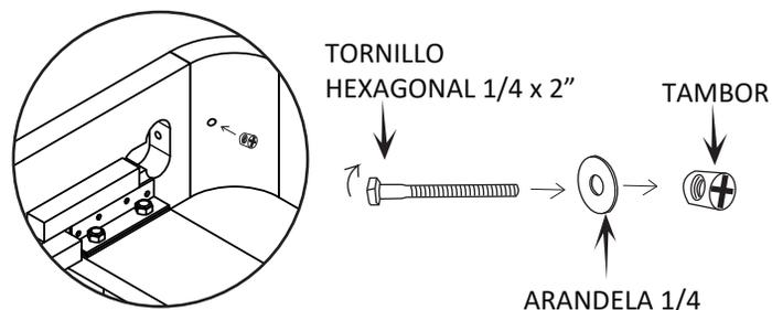
! UNA LARGUERO Y PIECERO CON EL TORNILLO HEXAGONAL AJUSTE CON LLAVE FIJA DE 1/2
